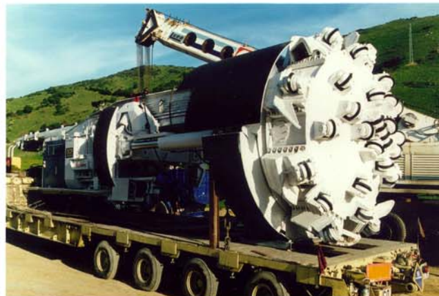
Tuneladora Ø 3,80 m utilizada en la Galería de Tarifa
