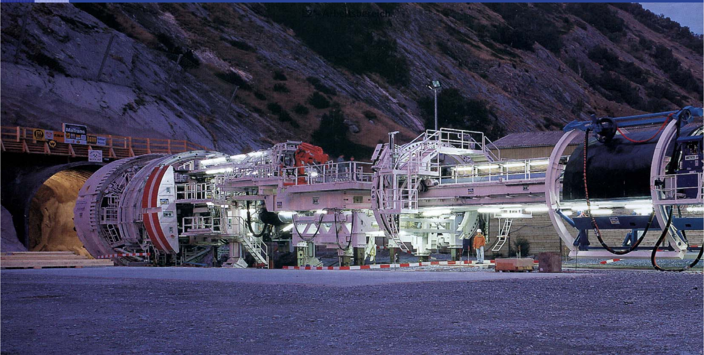
TBM Herrenknecht - Lötschberg Base Tunnel ( \phi=9.43\text{m} )
